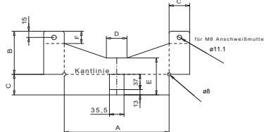
Odstup od steny nastaviteľný 50-150 mm
